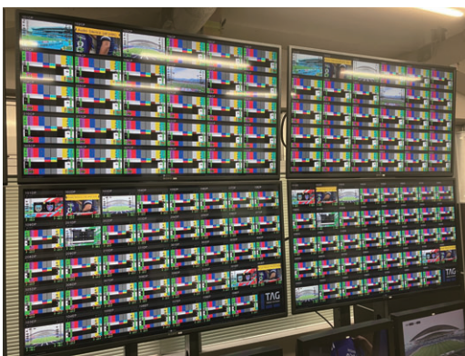
MCM-9000のペナルティボックス機能により、エラーを検知したストリームにはアラート(黄色バー)が表示される。
